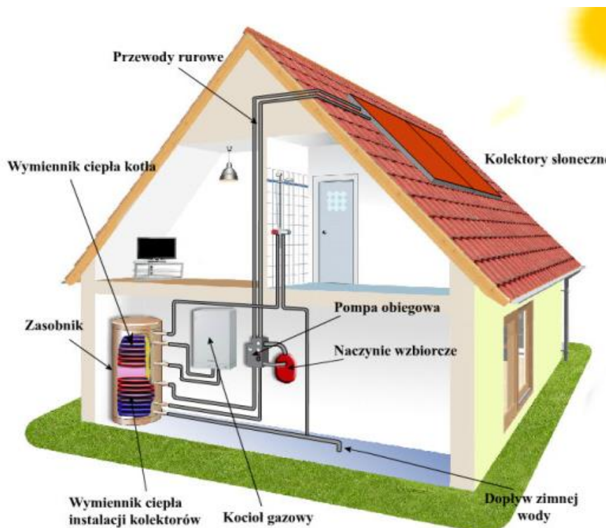
Ryc. 13. Schemat instalacji kolektorów słonecznych w domu jednorodzinnym
