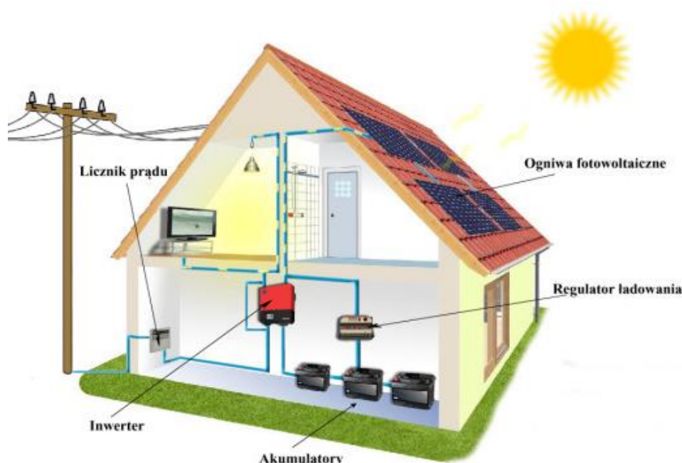
Ryc. 14. Schemat instalacji fotowoltaicznej w domu jednorodzinnym
