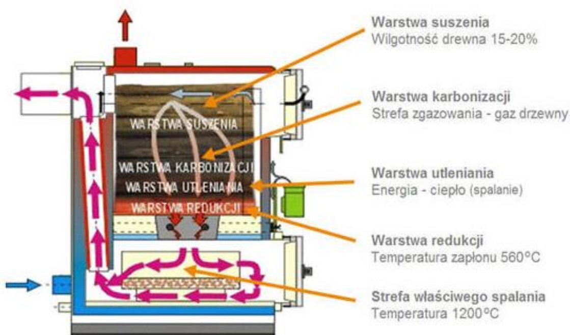
Ryc. 18. Schemat spalania drewna w kotle zgazowującym
